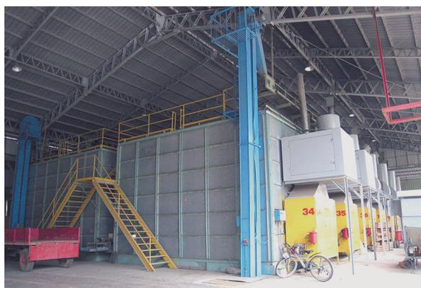
圖 3. 熱風乾燥設備
