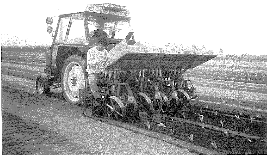
曳引機承載二畦四行式蔬菜開溝、移植、扶正、作畦、覆土、鎮壓一貫機械作業情形
