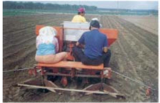
圖2. 日本十勝牌馬鈴薯半自動落種改良作畦 植、覆土、鎮壓一貫作業機
