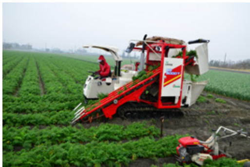
圖 6-9、東勢果菜生產合作社一貫作業 ( 拔取、切除地上部、胡蘿蔔裝袋 ) 收穫機採收示範
