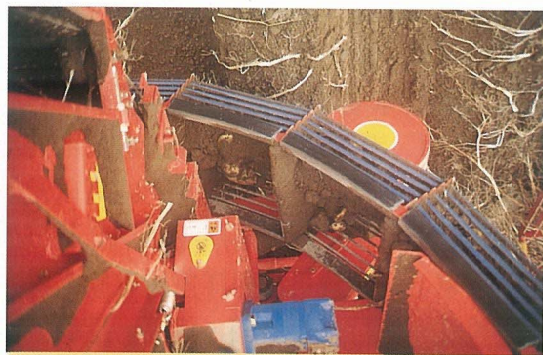
圖 5 馬鈴薯採收機圓盤式輸送至滾動式輸送帶
