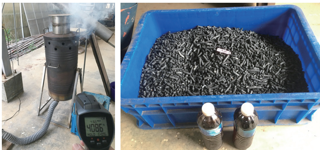
圖2. 種苗改良繁殖場執行使用後菇包介質經壓縮造粒，採用(左)簡易型TLUD炭化爐具收得(右)生物炭成品及冷凝木醋液
