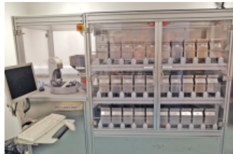
圖 2-20、全世界僅有三台之種子樣品 3D 攝影掃描器，可快速進行分析送驗樣品是否符合可接受檢驗的樣品，加速檢測流程。
