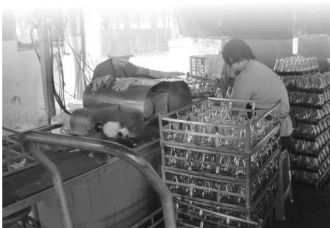
組織培養瓶的清洗多以簡易機械搭配人力個別單瓶的清洗
