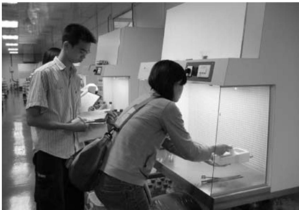
組織培養無菌操作台落菌量檢測
