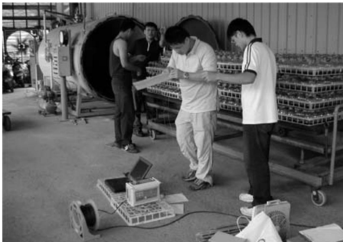
組織培養基殺菌釜內部溫度檢測
