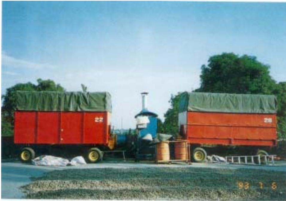
拖車式乾燥車箱乾燥落花生莢果機械設備
