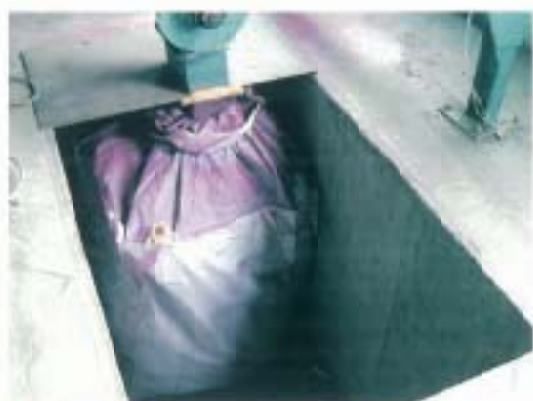
圖 6-2、改善後集塵槽利用大型集塵袋收集
