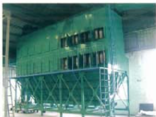
圖 6-1、布管式集塵設備
