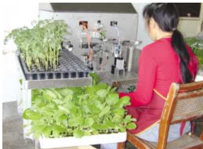
圖6-2、套管式機械嫁接作業情形
