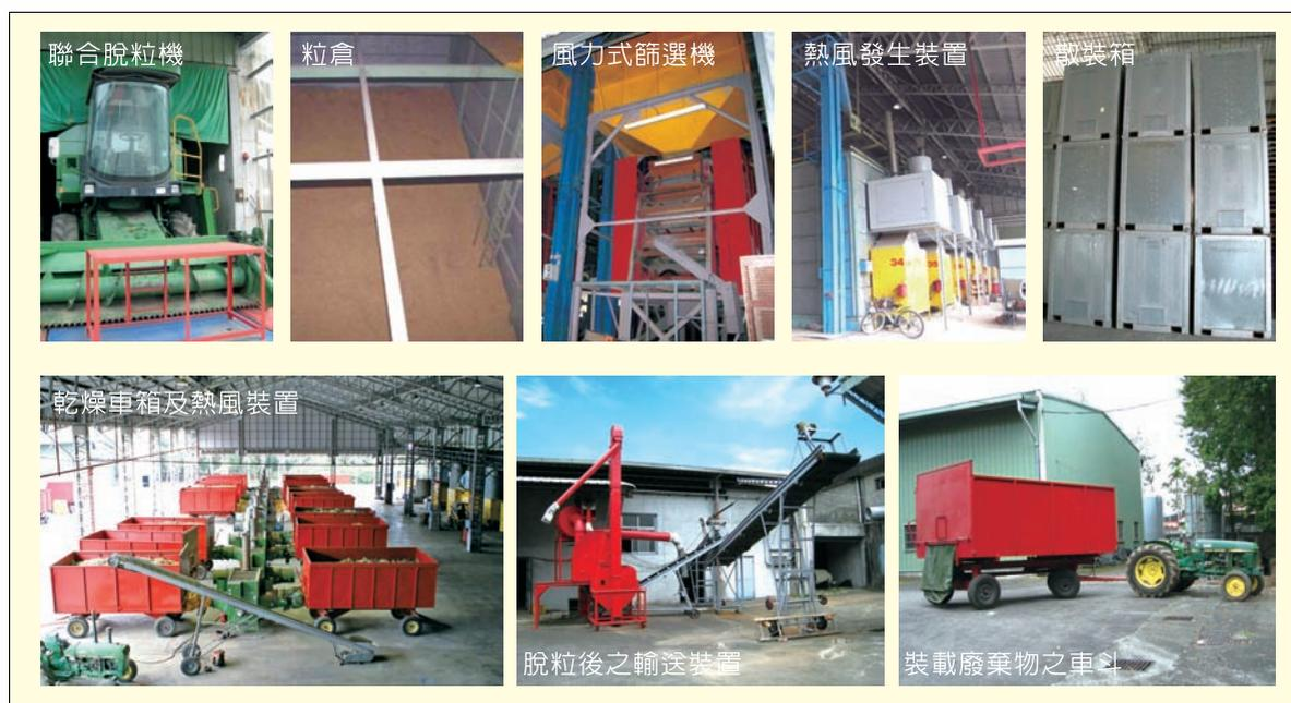
圖 6 高粱調製作業線機械設備
