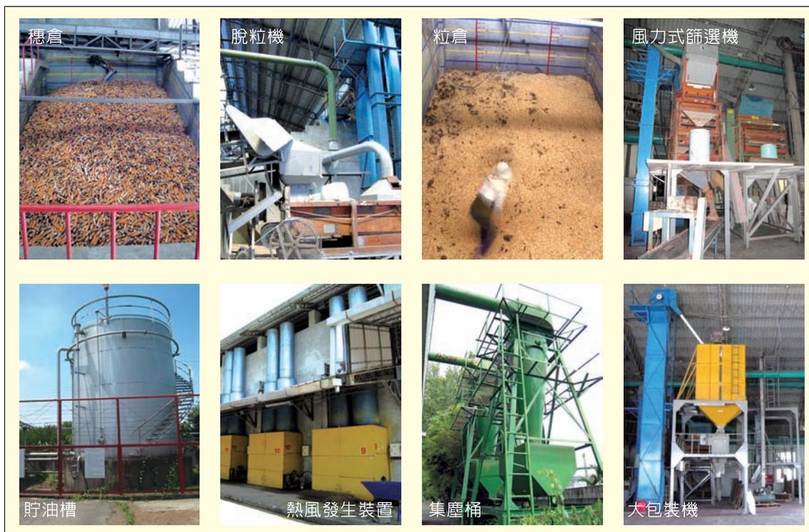
圖 5 玉米種子調製作業線機械設備
