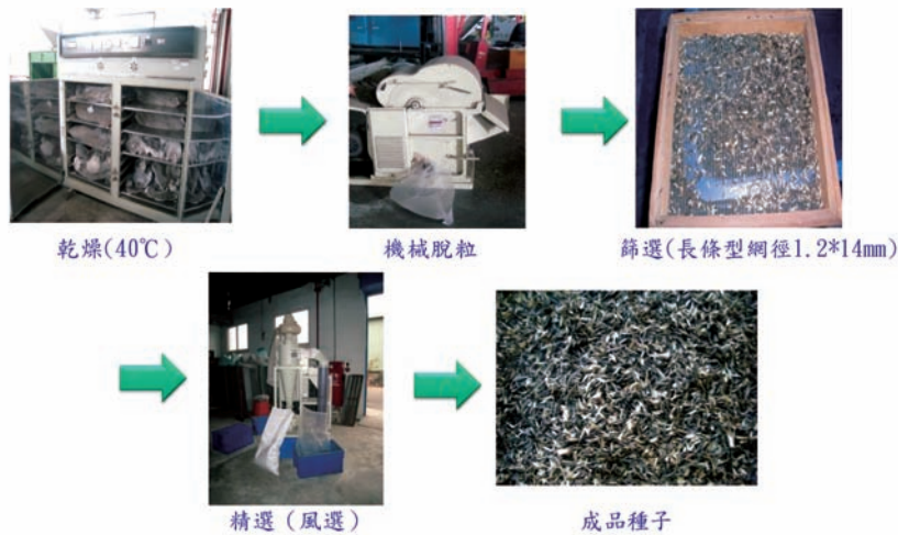
圖 1 | 波斯菊種子調製作業流程圖
