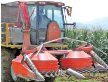
圖 7-6、畜產試驗所青割玉米採收機械
