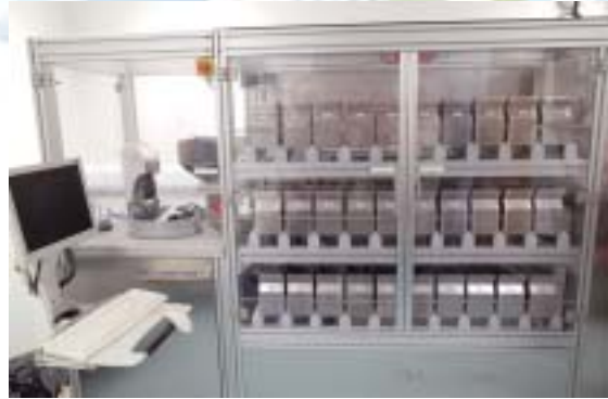
圖 4 | 全世界僅有三台之種子樣品 3D 攝影掃描器，可快速進行分析送驗樣品是否符合可接受檢驗的樣品，加速檢測流程。
