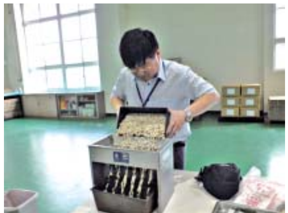
圖 3 取樣員操作土壤分樣器進行樣品的減量
