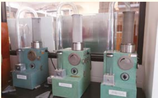
圖 5. 不同作物種子有固定使用的種子風選機，可減少誤差產生
