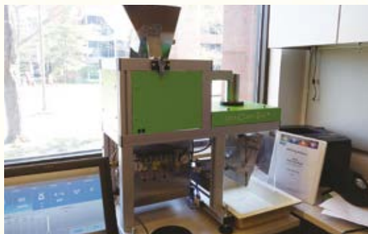
圖 4. 影像感應式種子計數器可將同時經過攝影鏡頭落下的種子正確計數
