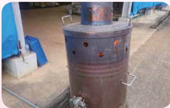
圖 3. 種苗場簡易型 TLUD 炭化爐
