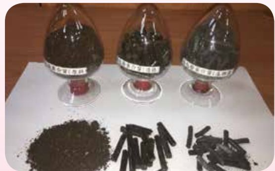
圖 4. 左：菇包廢棄介質、中：菇包造粒介質、右：菇包生物炭
