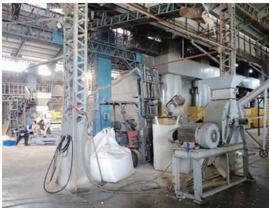
圖 1. 本場採收之玉米種穗乾燥後，經脫粒機分離種子及穗軸，並連結玉米穗軸破碎資源化處理，渣粕粉塵則由風管系統集中回收
